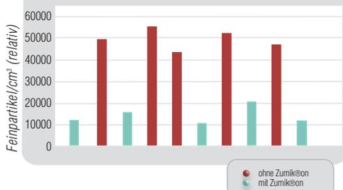
Die Abscheideeffizienz im Rahmen der Versuchsreihe an der Pilotanlage variiert zwischen 57% und 81%, was einem Mittelwert von 73% entspricht.
