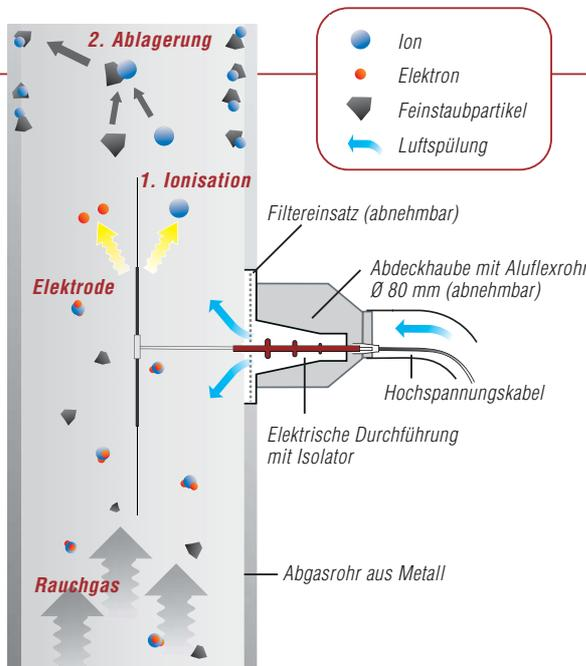
1. Bei ausreichend hoher Spannung an der Elektrode in der Mitte des Abgasstroms kommt es zu Ionisierungsprozessen. Somit entstehen im Abgasstrom geladene Teilchen, sogenannte Ladungsträger, und Gasionen.
